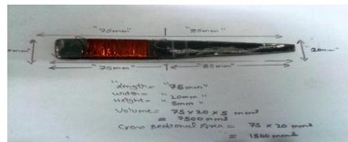
Fig 9 Hammered Bar (75\*20\*5) mm<sup>3</sup>
