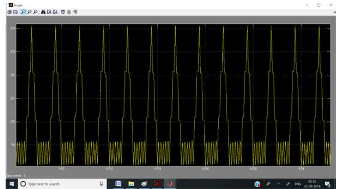
**Fig-14 : New : DC bus voltage ripple (198 volt to 204 volt approx)**
