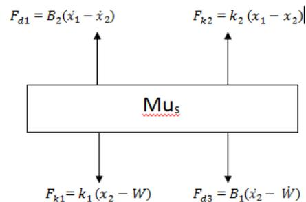
$$\sum F_{ms} = F_{d1} + F_{k2} - F_{k1} - F_{d3} = M_s \ddot{x}_2$$
