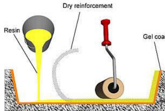
*Fig. 3. 1Hand Lay Up Process*
