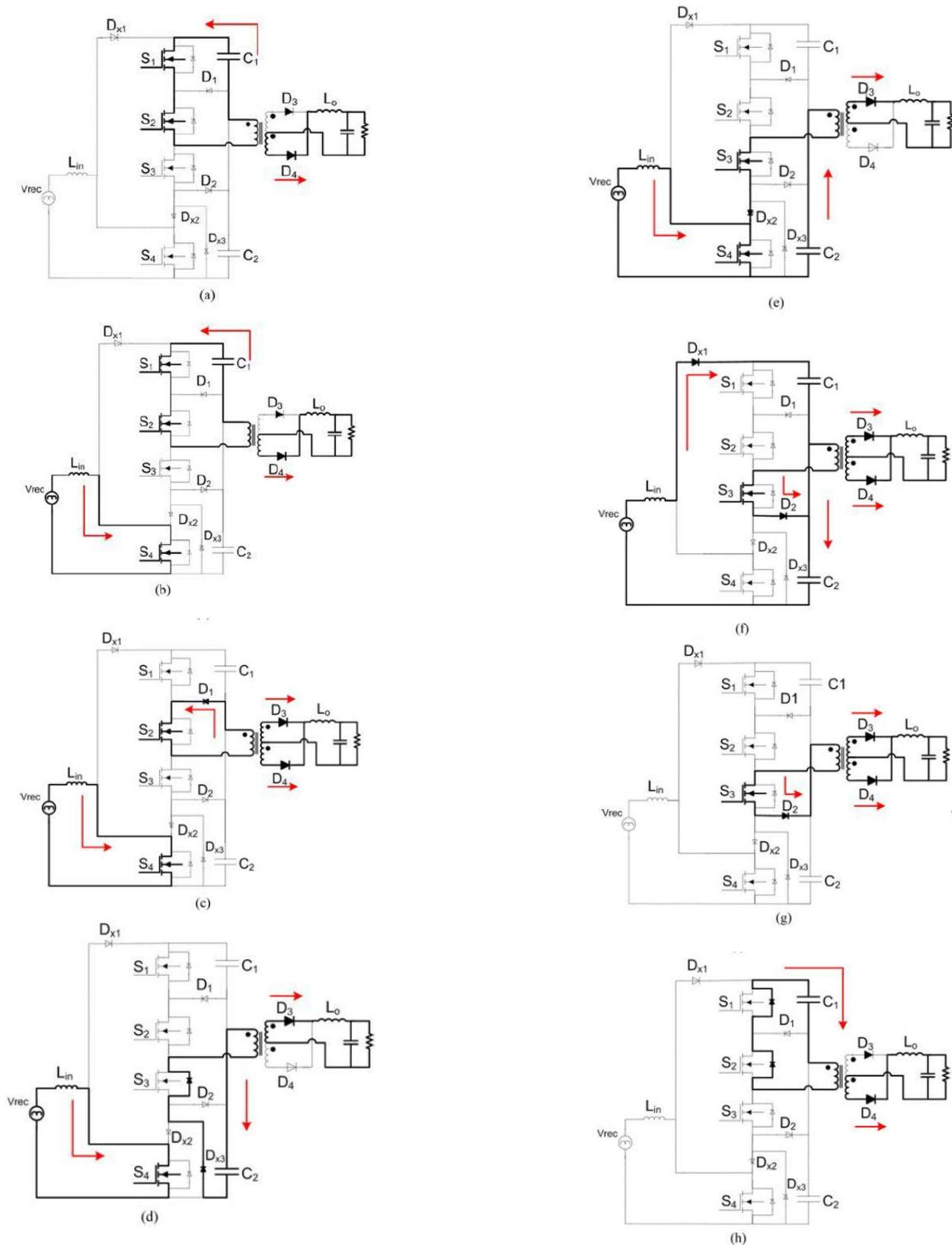
Fig 3: Equivalent circuits for each operation stage for the converter (a) Mode 1 ( $t_0 < t < t_1$ ) (b) Mode 2 ( $t_1 < t < t_2$ ) (c) Mode 3 ( $t_2 < t < t_3$ ) (d) Mode 4 ( $t_3 < t < t_4$ ). (e) Mode 5 ( $t_4 < t < t_5$ ) (f) Mode 6 ( $t_5 < t < t_6$ ) (g) Mode 7 ( $t_6 < t < t_7$ ). (h) Mode 8 ( $t_7 < t < t_8$ ).
